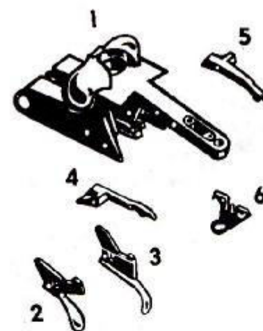
Рисунок 4 – Детали спускового механизма ружья MP-43 и его модификаций с автономными спусковыми крючками
